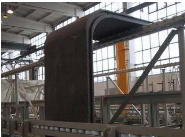
Element kątowy POLYCRETE® do wyłożenia kolektora zbiorczego
